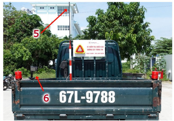
Vị trí lắp đặt thiết bị kiểm tra chiều cao phía sau thùng xe và Camera ghi hình phía sau
