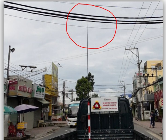
Hình 9: Trường hợp dây vượt đường không đạt độ cao tác động vào cần đo độ cao
