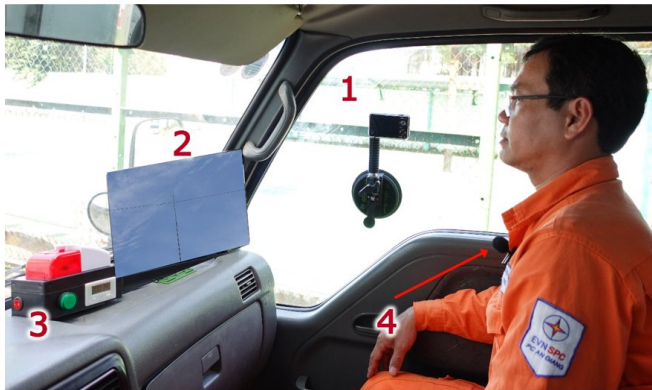
Vị trí lắp đặt Camera bộ xử lý trung tâm và Camera ghi hình phía trước cabin xe
