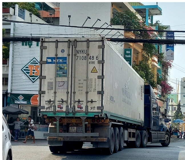
Hình 3: Ảnh do nhóm tác giả chụp được trên đường Thủ Khoa Nghĩa, TP Châu Đốc vào ngày 10/12/2022, tình huống xe container chạm vào đường dây thông tin à Đây là tình huống rủi ro cao
