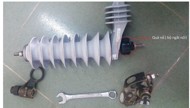
Bộ LA được tháo xuống, chuẩn bị lắp ráp LA khác đã được thử nghiệm.
