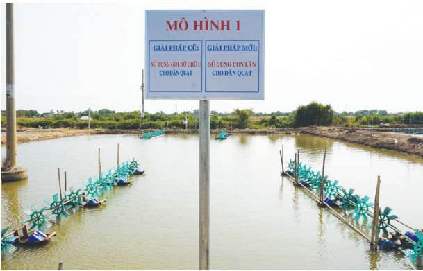
Mô hình Thay thế gố đỡ trực dân quạt (tạo khí ô-xy) chữ U bằng con lăn trực quay sau một năm thực hiện tại Sóc Trăng đã mang lại hiệu quả sản lượng điện tiết kiệm được 38,7% so với khi chưa áp dụng giải pháp
