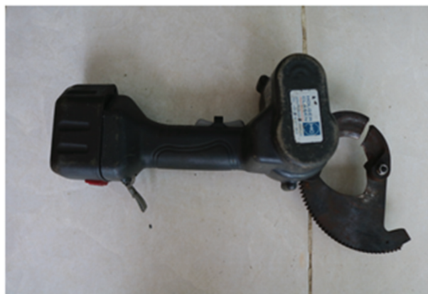
Kim cắt thủy lực dùng pin bị hỏng lưỡi cắt
