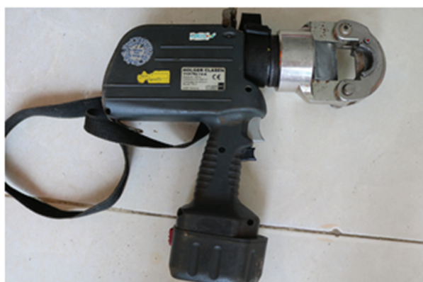
Khuôn cắt được lắp vào kim ép
