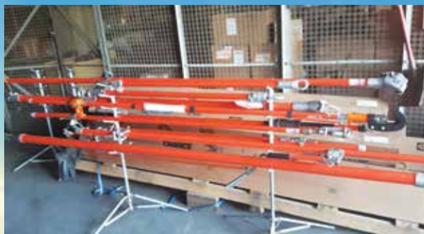
Dụng cụ thi công sửa chữa điện nóng hotline
