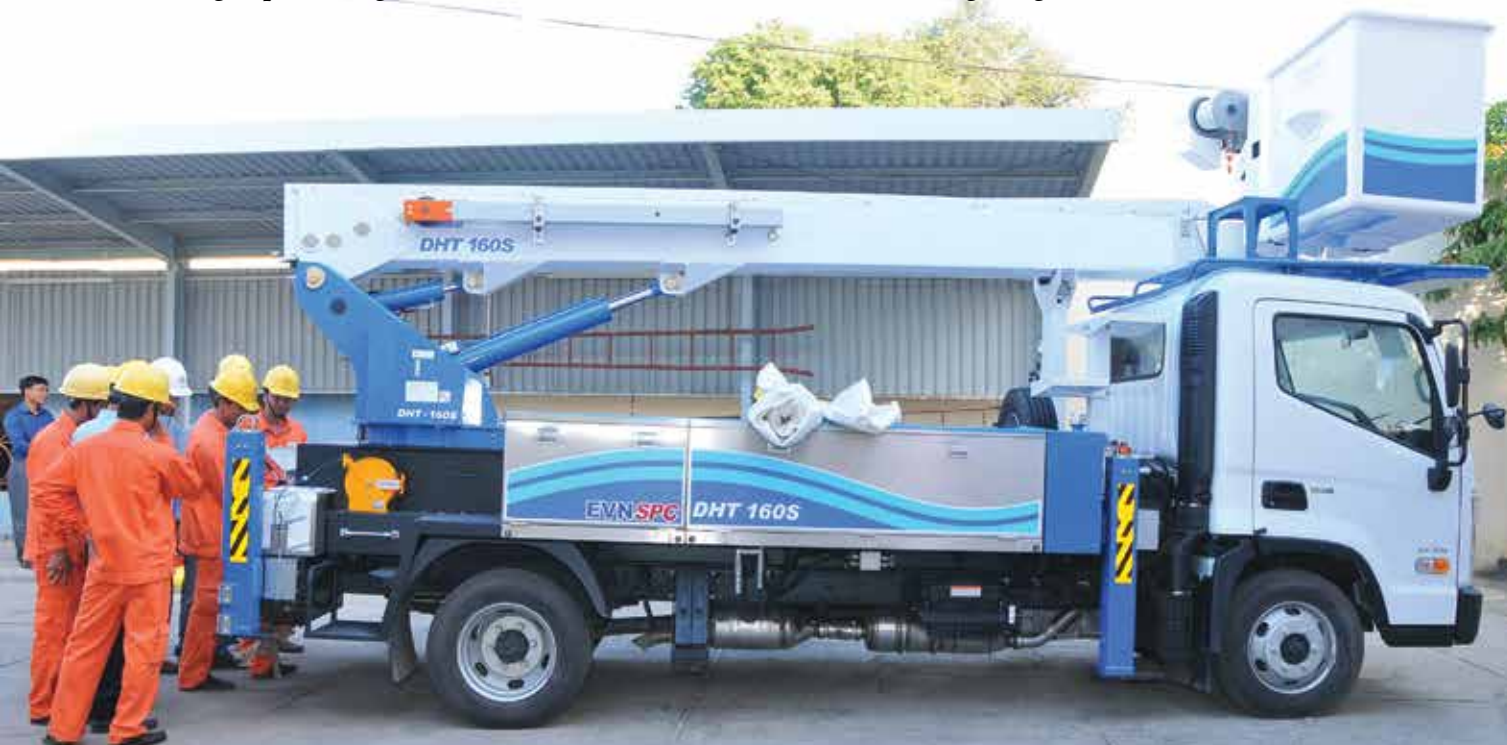
Xe gàu thi công sửa chữa điện nóng hotline
