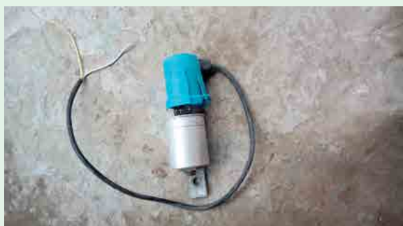
Tụ bù hạ áp lắp cố định bị bể nắp (trước khi áp dụng giải pháp)
